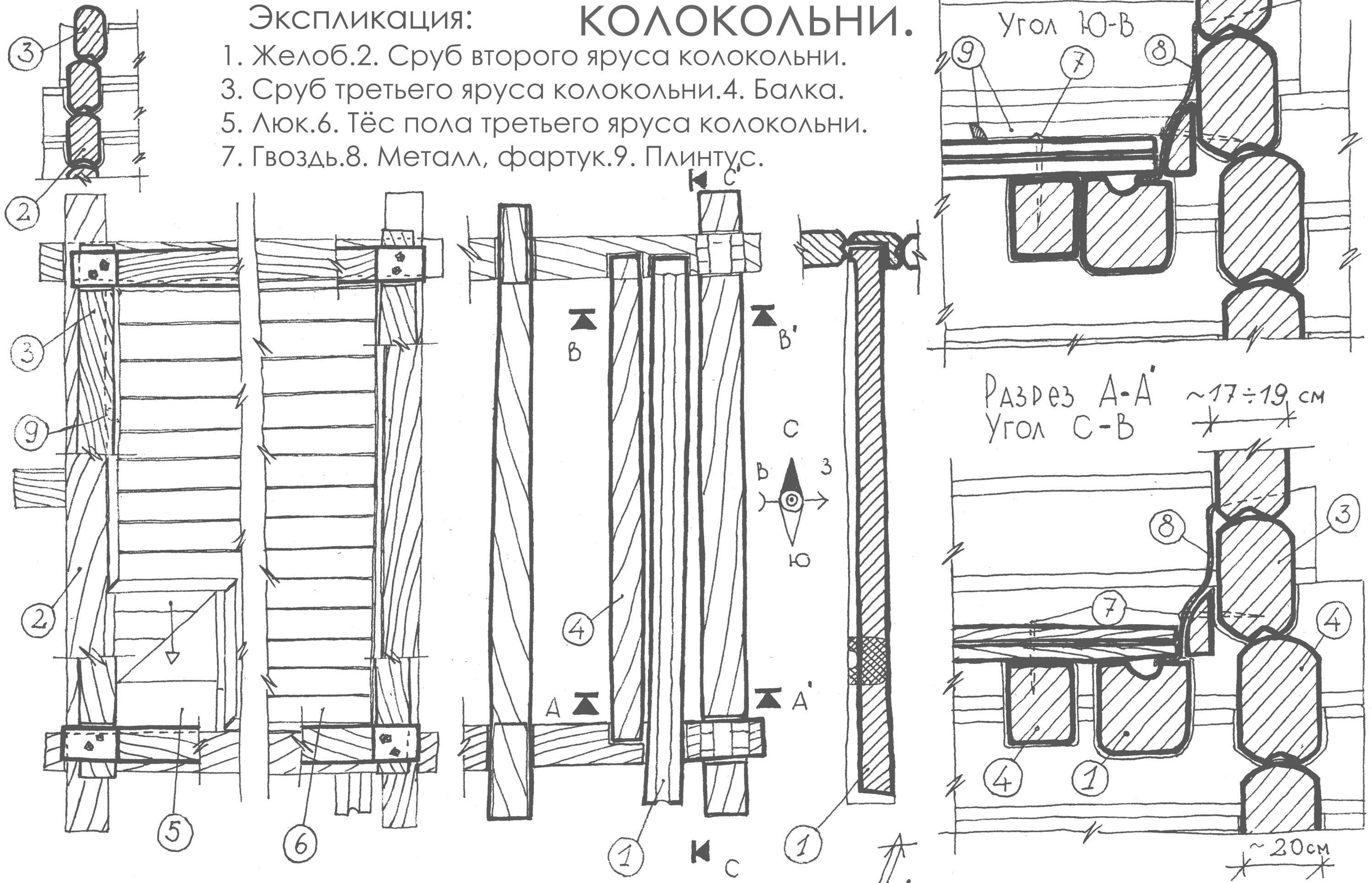
Рис. 5. Конструкция пола яруса звона колокольни.
