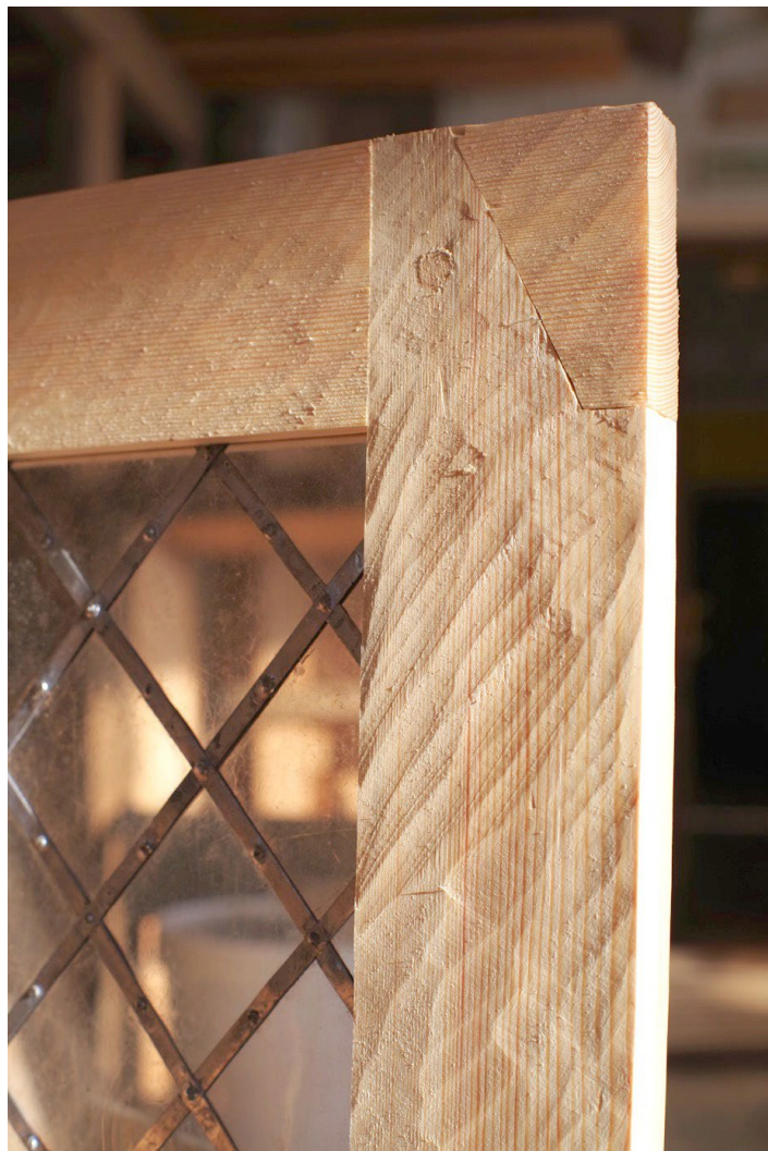
Илл. Д/3. Воссоздание слюдяных оконниц. Соединение рамы слюдяницы.
